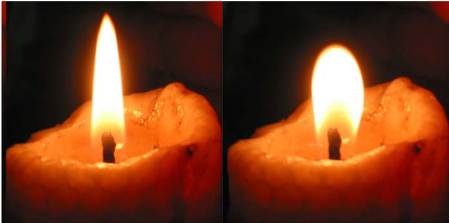
Figura 2.14: la fiamma di una comune candela (foto a sinistra) posta in prossimità di una sfera al plasma subisce una variazione rispetto alla sua forma iniziale (foto a destra).
