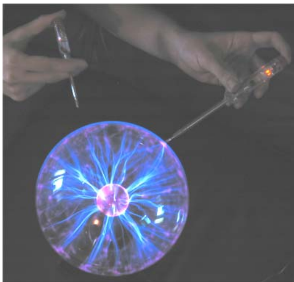
Figura 2.13: cacciaviti da elettricista in prossimità della sfera al plasma. Si osserva che la resistenza interna del cacciaviti a destra è molto più illuminata di quella del cacciaviti a sinistra perché il primo è più vicino alla sfera.
