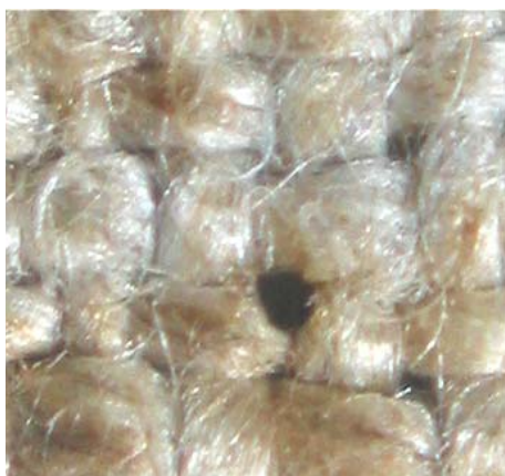
Figura 4.5: foro centrale generato dalla concentrazione localizzata di scariche continue.
